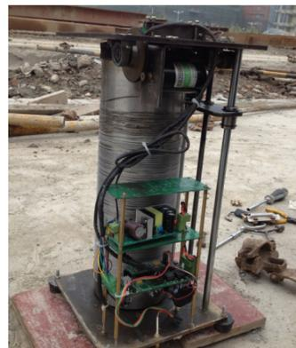
图4 QJCX60 测斜装置安装图
